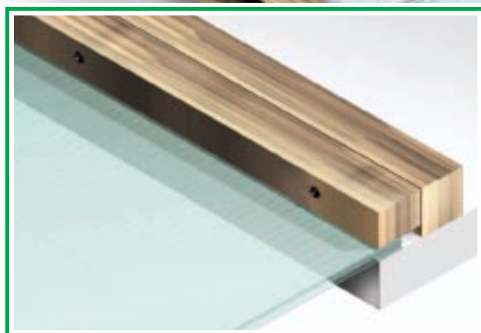
DETALLE DE FIJACIÓN CON DOBLE MARCO DE MADERA
